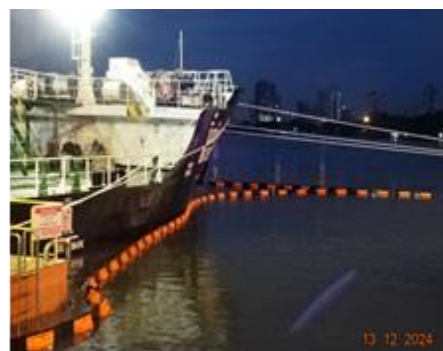
ภาพที่ 2-3 การล้อมทุ่น (Boom) รอบลำเรือบรรทุก
