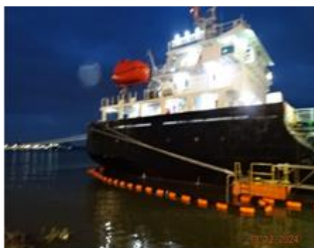
ภาพที่ 2-3 การล้อมทุ่น (Boom) รอบลำเรือบรรทุก
